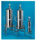
Gehäuse für die Filtration in sterilen und hochreinen Fertigungslinien WS-Sanitary-Gehäuse erfüllen höchste Ansprüche. Sie sind mit einem Manometer mit Membrandruckmittler und TriClamp, einem Sanitary-Entlüftungsventil und einem eintrittseitigen Sanitary-Ablaßventil ausgestattet.
