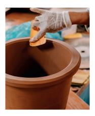
Die Filter werden in einer Fabrik in Pakse aus lokalen Materialien – roher Ton und Reisschalen – gemischt und in Form gepresst. Dank der langjährigen Nutzung der keramischen Wasserfilter, werden weniger Plastikflaschen gebraucht und weggeworfen.
